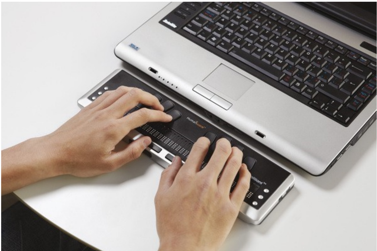
Брайлевский дисплей - это устройство вывода, предназначенное для отображения текстовой информации в виде шеститочечных символов азбуки Брайля. Источник: https://bit.ly/2EE1gV3
